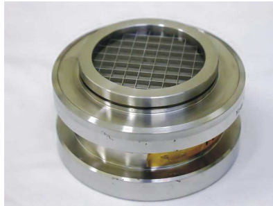
Figure 10.7: Imagen de una de las ventanas instaladas en CAST para la contención del Helio gas en el campo magnético de CAST.
