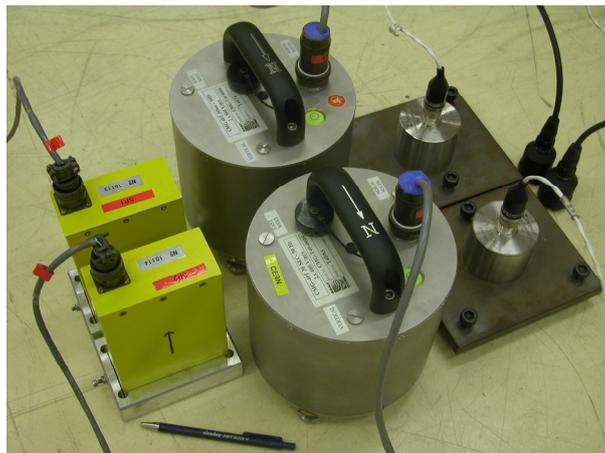
*Figure 3.3 : Installation expérimentale réalisée pour mesurer le mouvement du sol et le bruit interne des capteurs SP500, GURALP CMG-40T, ENDEVCO 86 et 393B12*
