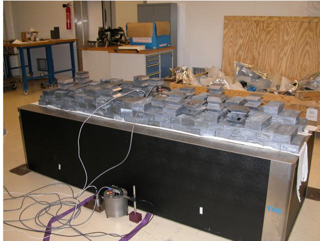
*Figure 6.11: Photographie de l'installation expérimentale réalisée pour mesurer les vibrations du sol et de la table lorsque des masses de plomb étaient posées sur la table*
