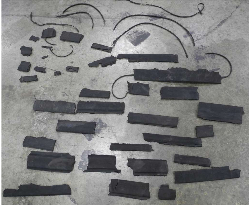
FOTO, de RESTOS DEL MATERIAL (CAUCHO) RECUPERADOS DE PISTA DE DESPEGUE DE SPOU, ENVIADOS A "GOODYEAR"
