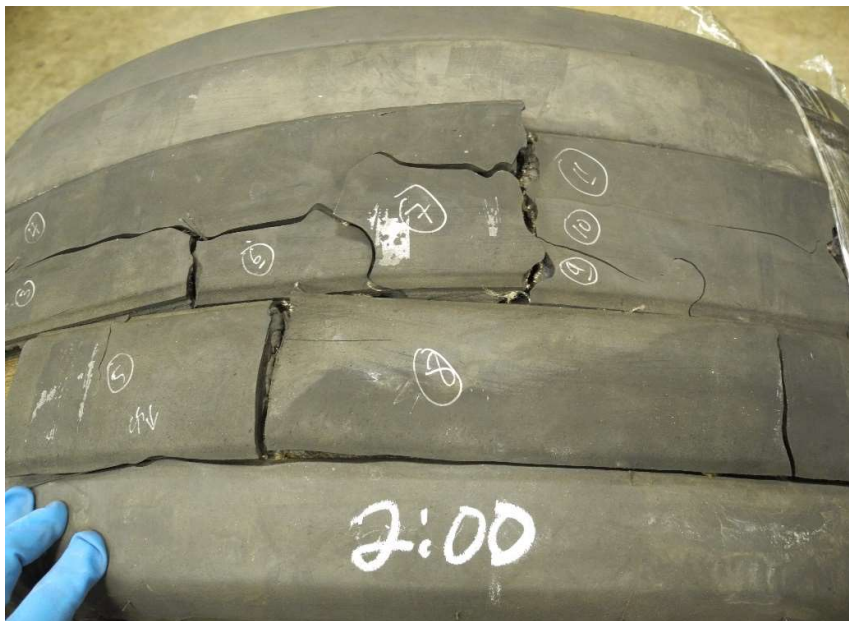
FOTO, de RESTOS DEL MATERIAL (CAUCHO) UNIDOS A NEUMATICO #2 EN "GOODYEAR" PARA ANALISIS
