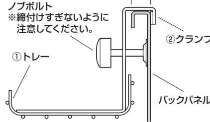
※クランプをバックパネルに差し込み、トレーが水平になるまでノブボルトを締め付けます。
