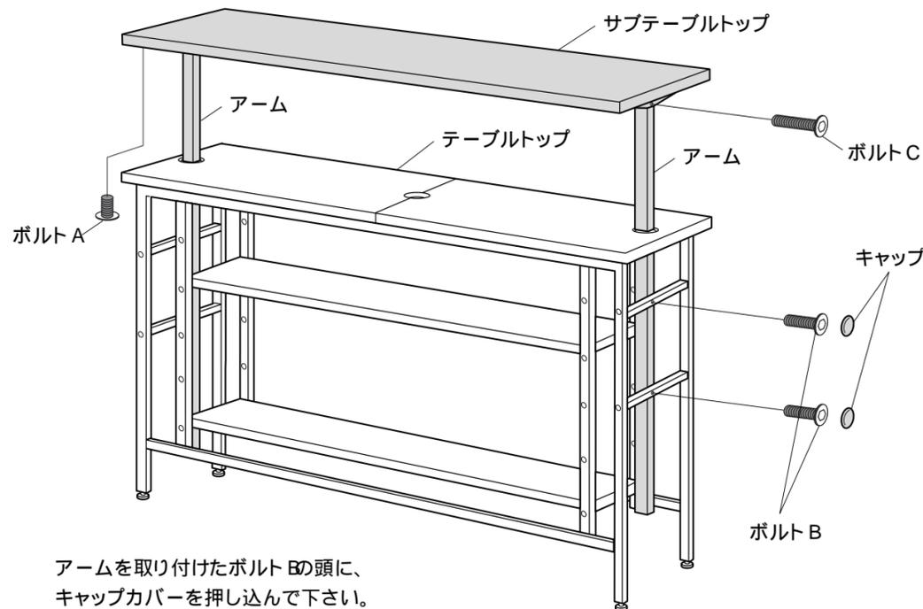
アームを取り付けたボルト B の頭に、キャップカバーを押し込んで下さい。
