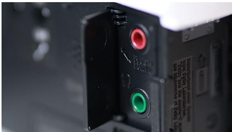
図 3. 赤がステレオマイク入力端子、 緑がステレオヘッドホン出力端子
