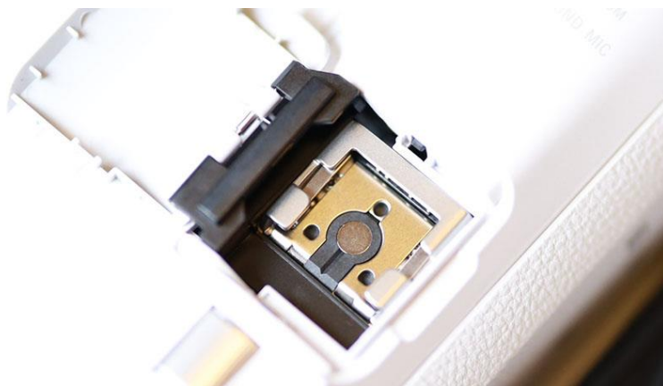
図 2. ホットシューは、メーカーによって純正のアダプタが必要な場合があります
