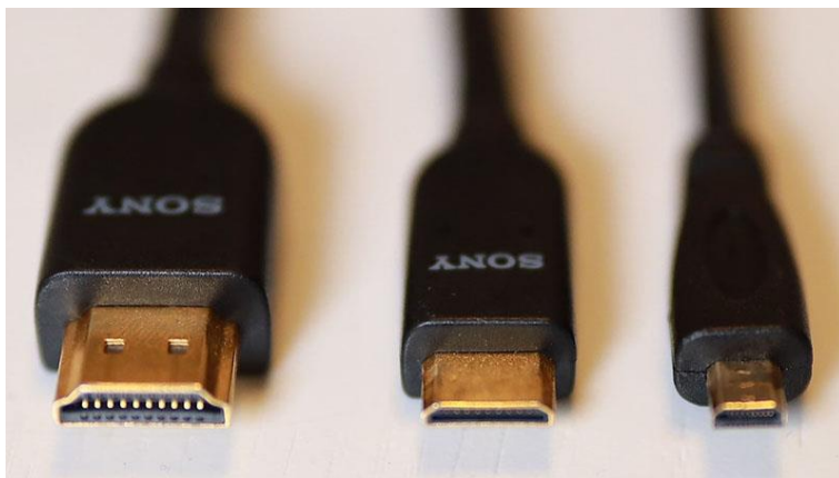
図 5. 左から順にタイプ A、タイプ C(ミニ HDMI)、タイプ D (マイクロ HDMI)
