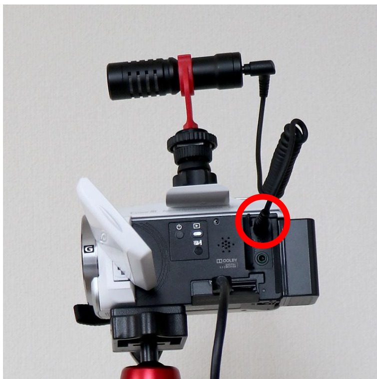
図 17. マイク入力端子にガンマイクを接続
