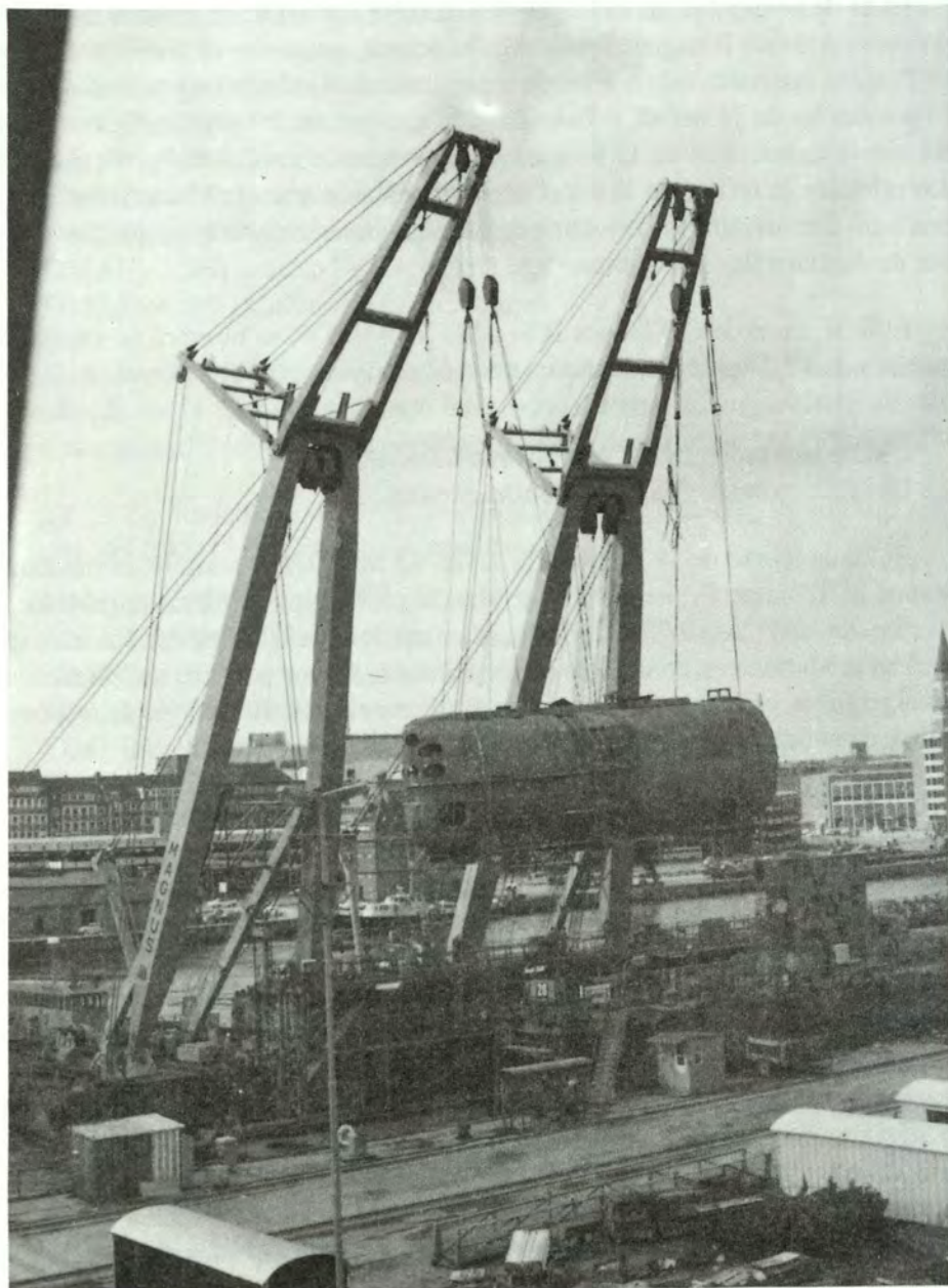
En los astilleros de Kiel, armando la sección de proa del proyecto 209 (BAP "Islay").
