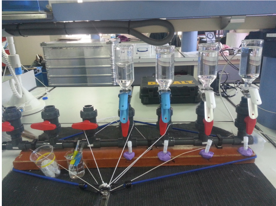
Figura 2: Rampa de filtración.
