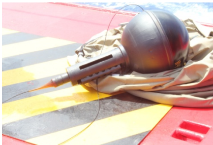
Fig 4. Flotador derivante PacificGyre y prototipo ICM con medida de salinidad a 9, 23 y 49 cm
