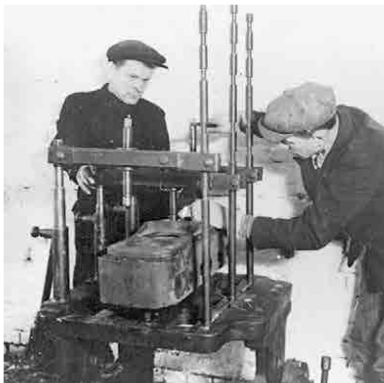
Барышевская МТС. Узловой метод ремонта в мастерской
