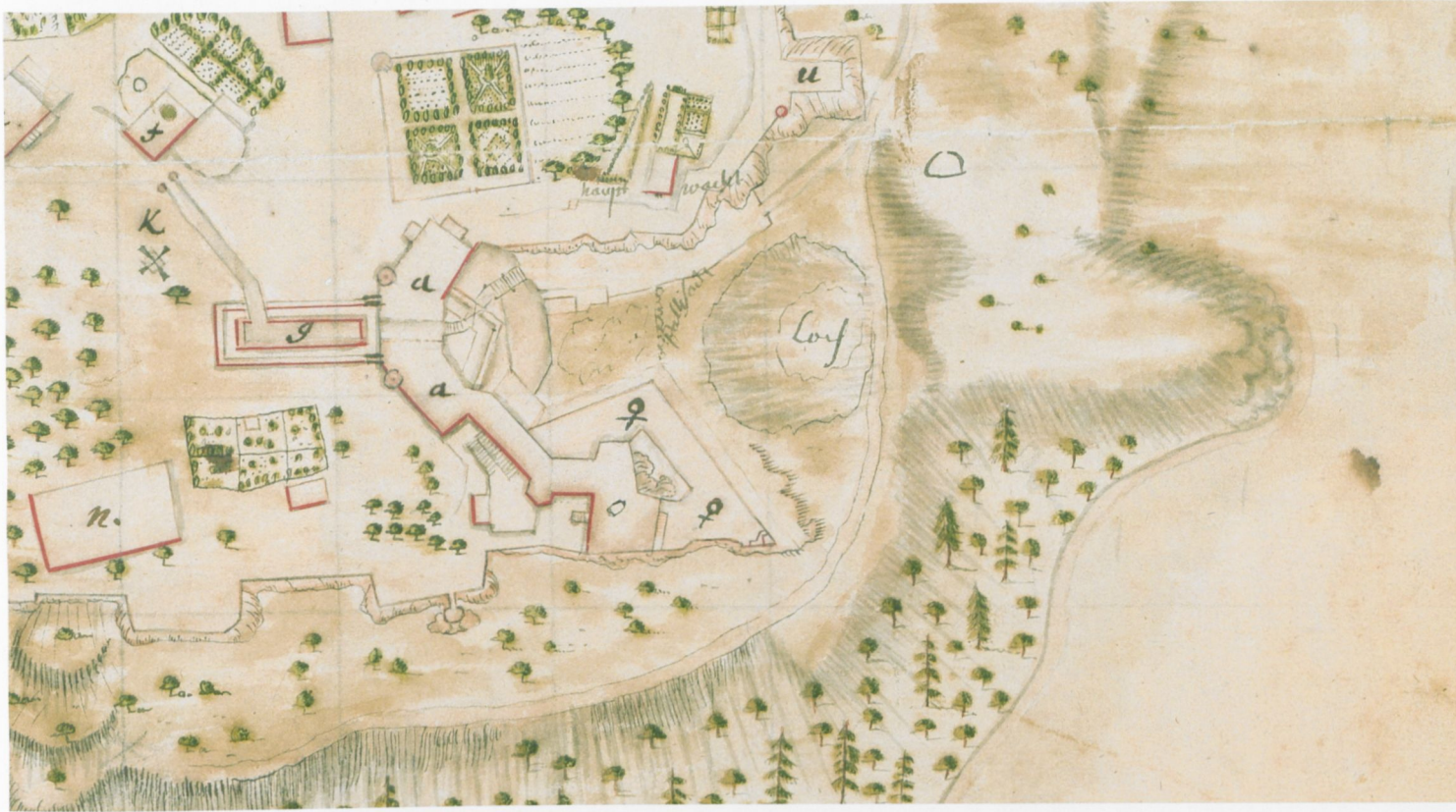
Abb. 9 Festung Königstein, Eingangsbereich mit Georgenbastion und dem alten Ravelin vor dem Torhaus. Ausschnitt aus dem »Grundriss der Churfürstl. Sächs. Grantz Vestung Königstein Anno 1709«
