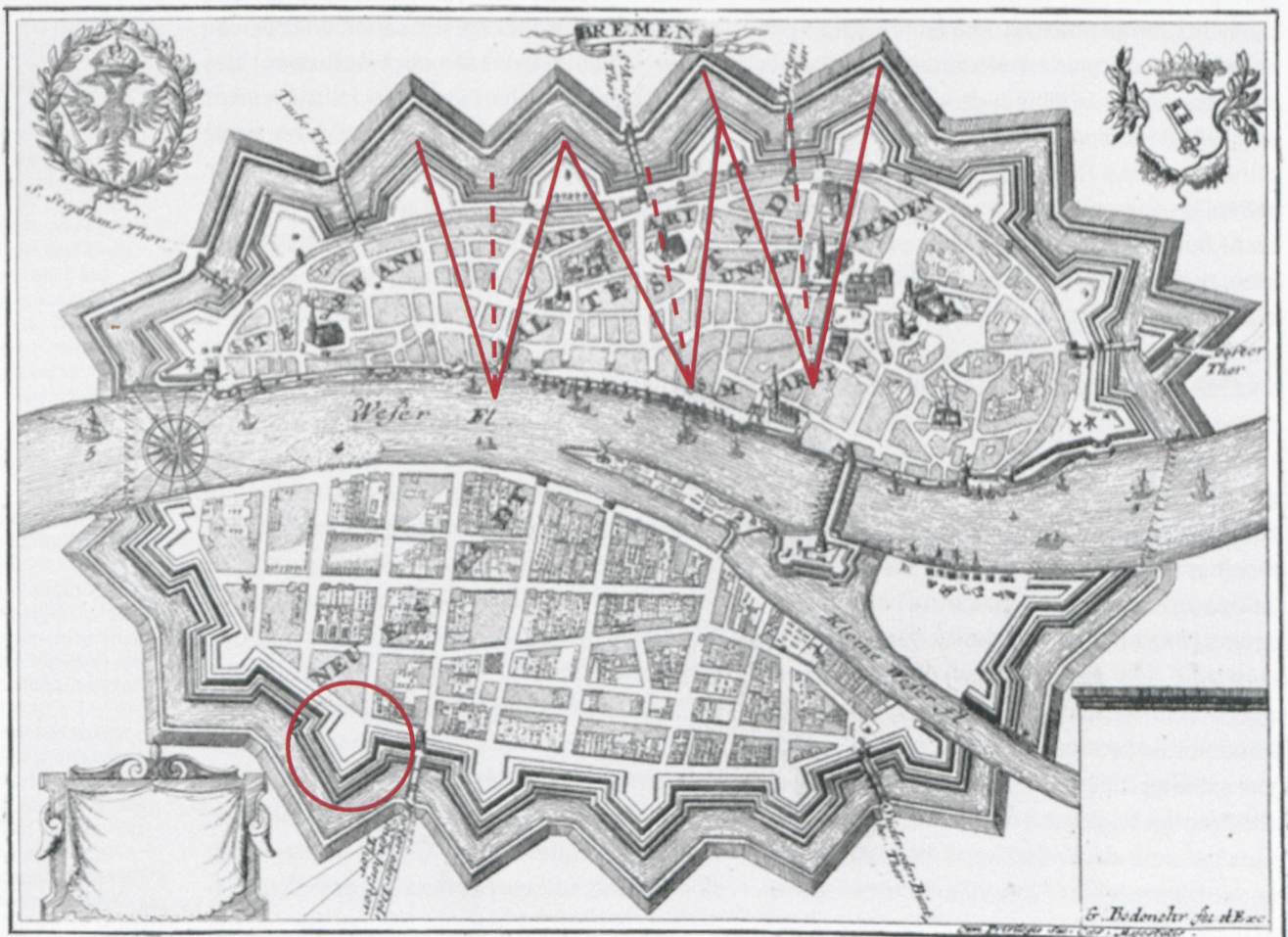
Abb. 5 Kombination von Wallabschnitten am Beispiel der Stadtbefestigung von Bremen; die Wallabschnitte folgen im Einzelnen regelmäßigen Proportionen; die Kombination unterschiedlich großer Proportionen lässt somit auch Befestigungen irregulärer Grundrisse zu; die Fortifikation ist zwar geometrisch unregelmäßig geformt, aber dennoch den fortifikatorischen Regeln gemäß
