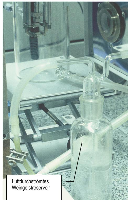
Abb. 7.4\_8 Anordnung der DMA- Messapparatur durch Garry Foster. Im Vordergrund sieht man das Weingeistreservoir in der Wulfschen Flasche. Im Hintergrund die Messzelle (□) im Glaszylinder mit Schlauchanschluß für die Weingeistzufuhr
