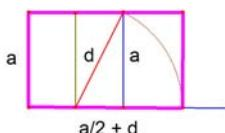
FIGURA 8: Construcción de un rectángulo áureo
