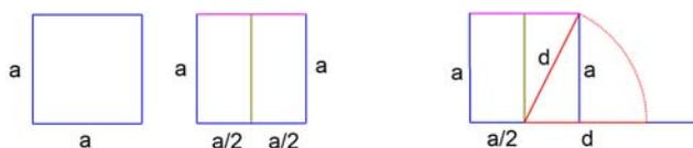
FIGURA 7: Construcción de un rectángulo áureo
