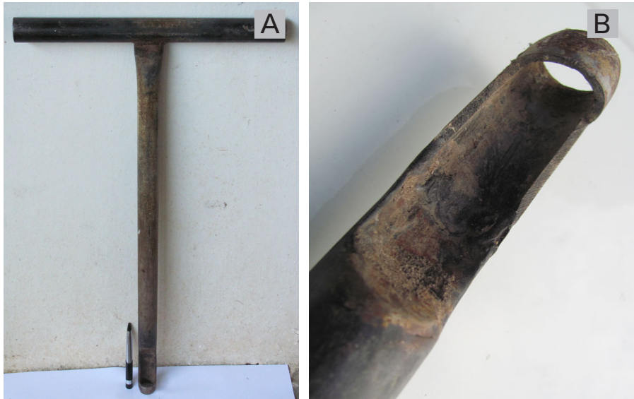
Figura 2. “Lurdinha”, ferramenta usada para desbaste em bananeira.
