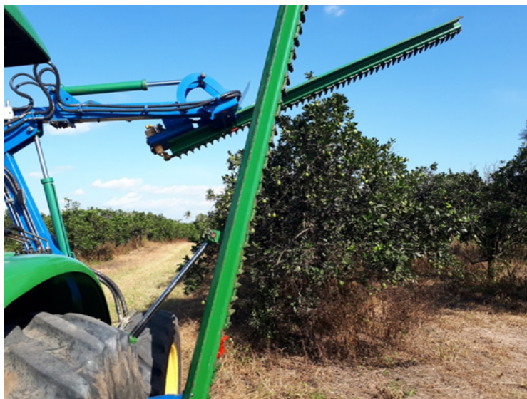
Figura 2. Poda mecanizada utilizando-se equipamentos acoplados ao trator.
