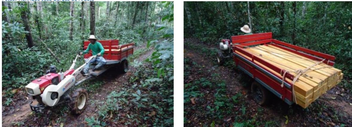
**Figura 2.** Sistema de manejo florestal comunitário do Projeto de Colonização Pedro Peixoto, AC: transporte primário da madeira serrada com microtrator e reboque.
