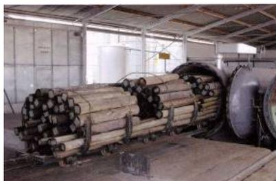
**Figura 3.** Carregamento de autoclave para tratamento por pressão, em usina de preservação de madeiras.
