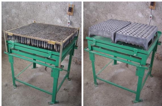
**Figura 2.** Mesa vibratória para o enchimento de tubetes em bandejas de plástico e de metal.
