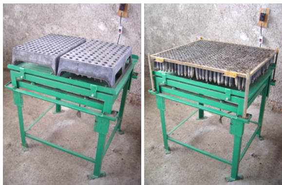
Figura 4. Mesa vibratória para enchimento de tubetes em bandejas de plástico e de metal.
