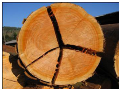
Figura 3. Extremidade de tora com rachaduras decorrentes da liberação das tensões de crescimento após o corte da árvore.
