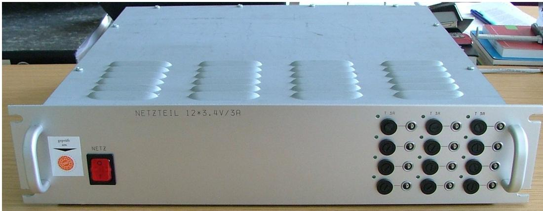
**Abbildung 5.2:** Das Netzteil zur Versorgung der LVDS-Splitter-Platinen. Abmessungen:  $B \times T \times H$ , (483)435x410x100 mm<sup>3</sup>. Design F. Bilger.
