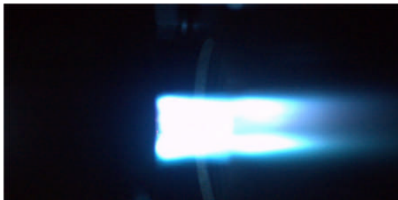
図 4 航空宇宙用プロトタイプエンジン始動時の燃焼発光例
