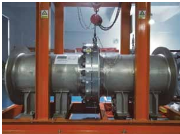
Figure1 実験に用いたASME クラス300 24インチ管フランジ締結体装置の写真
