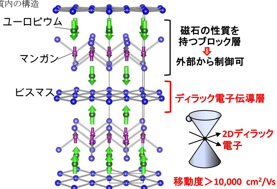
図 1: ディラック電子と磁性が共存する物質  $\text{EuMnBi}_2$  の結晶構造と磁気構造。正方格子を形成するビスマス（青色）がディラック電子状態を含有し、超高速電気伝導を担う。一方、ユーロピウム（緑）やマンガン（紫）からなる電気を流さない層（ブロック層）が磁石として機能する。各原子上の矢印は磁気モーメントの向きを表し、これらの相対的な角度を外場からの磁場で制御することにより、ディラック電子の電気の流れを劇的に変化させ、ディラック電子をビスマス層に閉じ込めることができるようになった。
