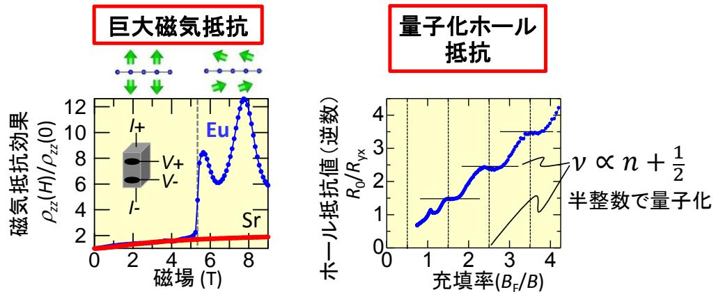
図 2：(左) EuMnBi<sub>2</sub> のディラック電子層に垂直方向の電気抵抗の外部磁場依存性。グラフ上部に描かれているように、ユーロピウムの磁気モーメントの向きを水平方向へ変化させると、EuMnBi<sub>2</sub> の電気抵抗（青）は急激に上昇することがわかる（磁気抵抗効果）。これは、ディラック電子が二次元的な面内に強く閉じ込められることを意味する。一方、磁石の性質を持たない SrMnBi<sub>2</sub>（赤）では、外部磁場により電気抵抗を大きく変化させることが出来ない。挿入図は、電気抵抗の測定法の模式図。
