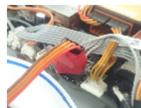
写真9 GNSSコネクター抜け防止対策
