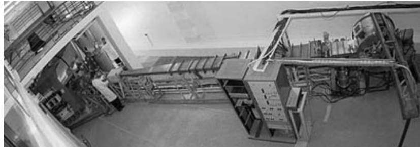
Рис. 6. Тракт выведенного пучка установки. Слева виден циклотрон, справа — камера для облучения пленки
