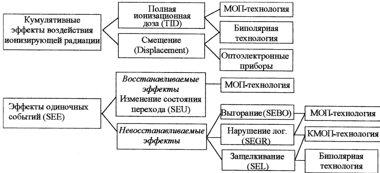
Рис.1. Основные радиационные повреждения ИС, характерные для экспериментальных установок на коллайдере LHC
