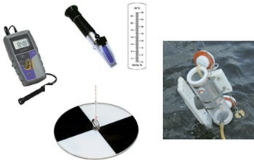
Figura 8. Equipos de campo utilizados para monitorear la calidad de agua en los sitios de cultivo de moluscos bivalvos: Multiparámetros (oxígeno, temperatura y pH), salinómetro, disco de Secchi y botella para toma de muestras de agua. Estos equipos se encuentran a un costo accesible en el mercado y deben considerarse como una inversión indispensable para tener buenas prácticas de cultivo. Fotografías http://mx.images.search.yahoo.com .
