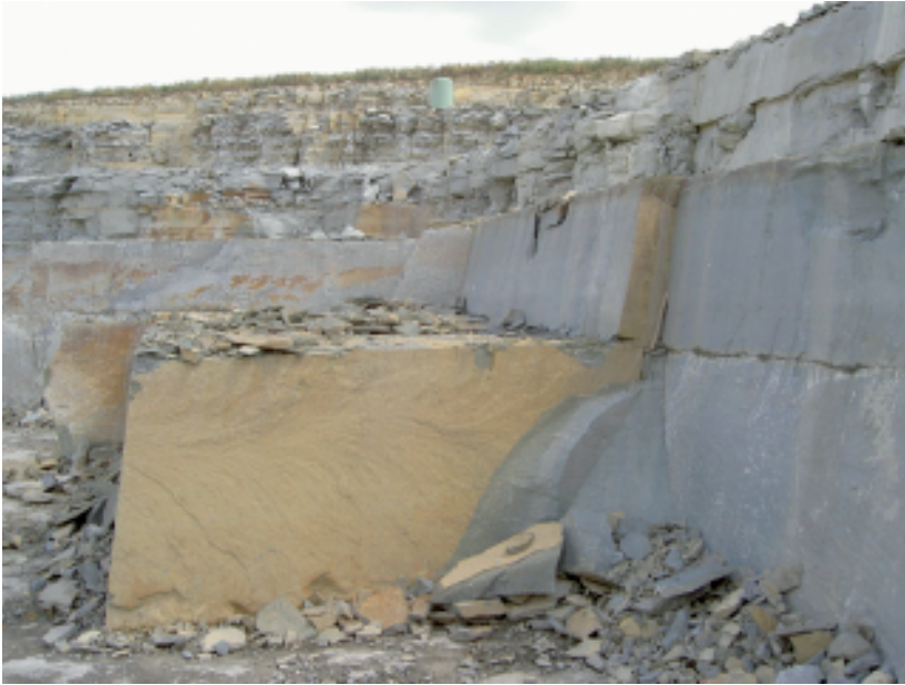
Abb. 10: Getrennter Abbau der unteren „Grünen Werksteinbank“ und der oberen „Blauen Werksteinbank“.
