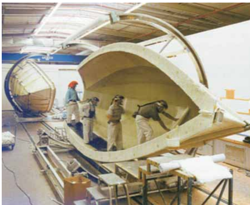
Joonis 1. Väikelaeva kere valmistamine käsitsilamineerimise teel [5]
