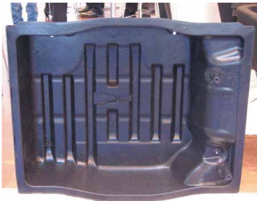
Joonis 4. SMC-meetodil (valupressimine) valmistatud klaasplastist (40%) varurattaalus
