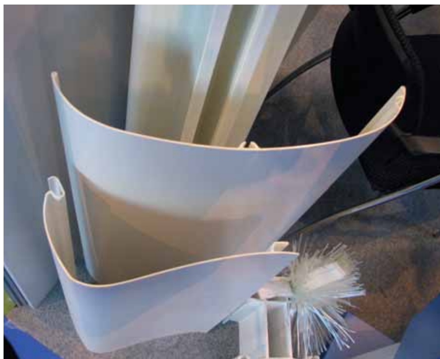
Joonis 6. Pultrusioonmeetodil valmistatud profileeritud komposiitplastlehed
