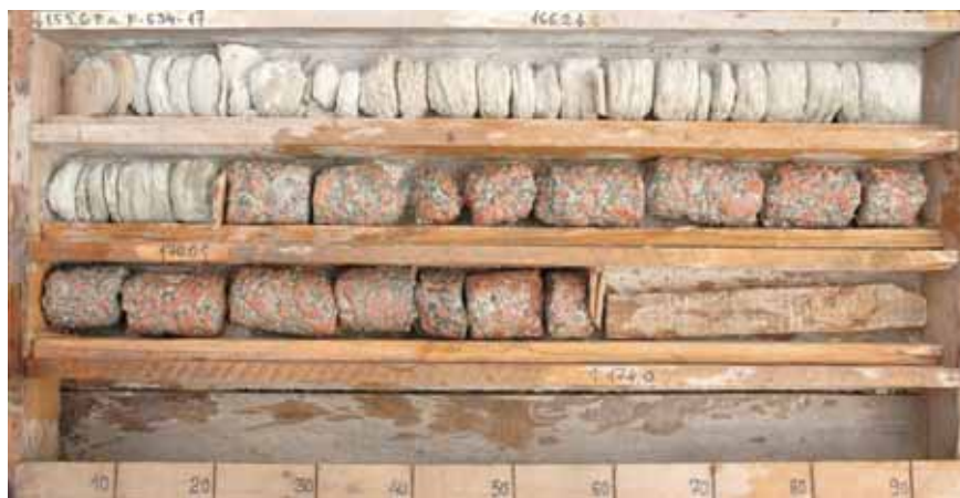
Joonis 9. Ediacara liivakivi (ülemine helehall) ja Neeme massiivi murenenud piiterliit umbes 170 m sügavuselt võetud puursüdamikus F534 (Maardu)
