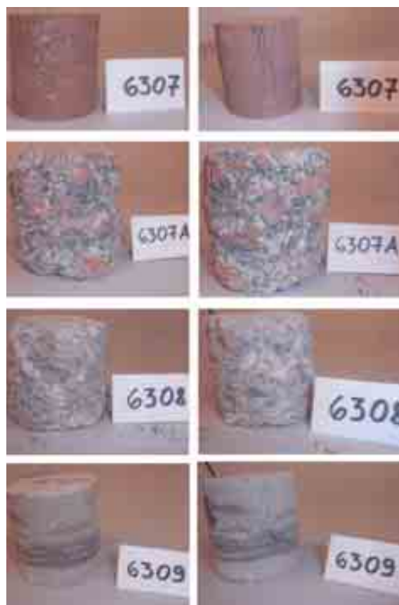
Foto 6. Maardu kivimite katsekehad enne (vasakul) ja pärast (paremal) survetugevuse määramist: 6307 – vendi aleuoliit; 6307A – murenenud piiterliit; 6308 – murenenud piiterliit; 6309 – vendi liivakivi
