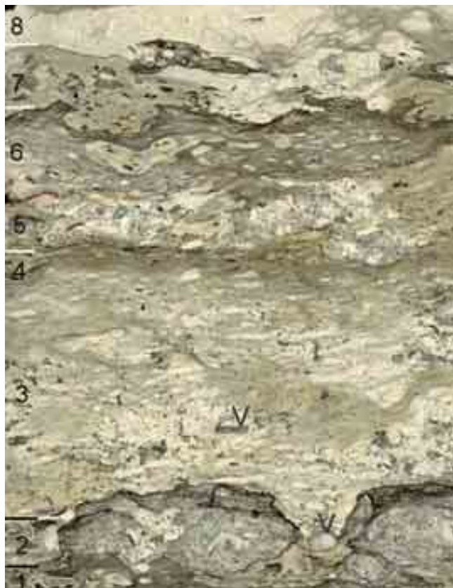
Foto 1. Kivi puursüdamik, sügavus 37,17–37,27 m, lihv: Ussikirjaline dolomiitjas savikas lubjakivi püriidistunud koprooliitide (mudasöojate ekskrementide) ja väikeste veeristega (kihid 1, 3, 6) ning detriitjas-purrulise puhtama lubjakivi katkendlike vahekihtidega (kihid 2 ja 5), samuti tumedama ussikirjalise domekivi õhukeste vahekihtidega (kihid 1, 4 ja 7). Lasum (kiht 8) on puhas tombuline lubjakivi. Kahel tasemel (kihtide 2 ja 7 all ja peal) esinevad ebatasased püriitsed taskutega katkestuspinnad. Iseloomulik varjatud šelfile
