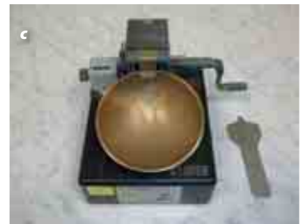
Joonis 5. Seadmed voolavuspiiri määramiseks: a on rootsi koonus, b Vassiljevi koonus ning c Casagrande aparaat
