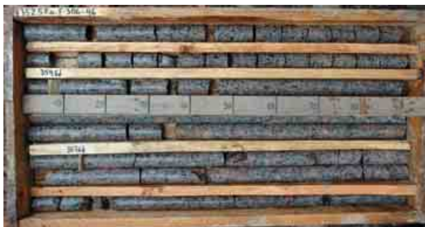
Foto 7. Märjamaa massiivi piiterliitne rabakivi Käbi puuraugu F306 puursüdamikust sügavuselt 352,6–360,5 m. Sellest võeti proov killustiku LA-katseks
