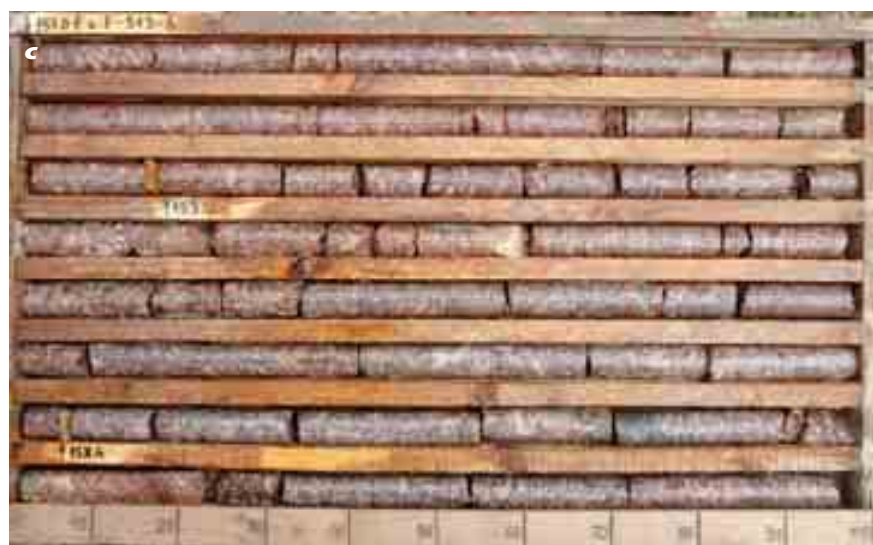
Foto 2. Maadu piiterliitne rabakivi: a puuraugust F503 sügavuselt 296,4–306,5 m, b puuraugust F532 (161,2–174,0 m) ning c puuraugust F533 (151,0–160,5 m)
