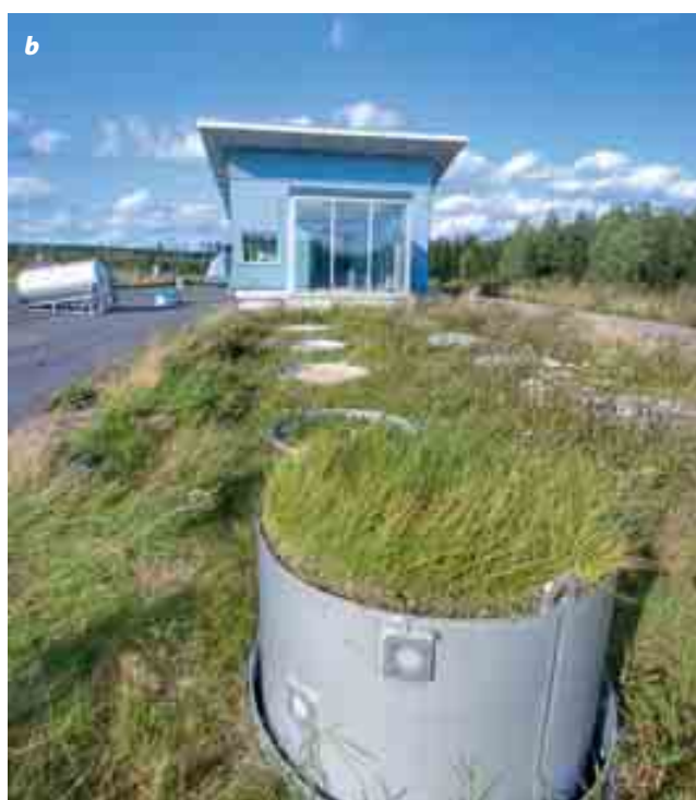
Foto 1. Mullauuringute Keskuse (Maaperätutkimuskeskus) labor Jokimaal, Lahtis: a on lüsimetrite (maht 2 m 3 ) maa-alused ja b maapealsed osad.
