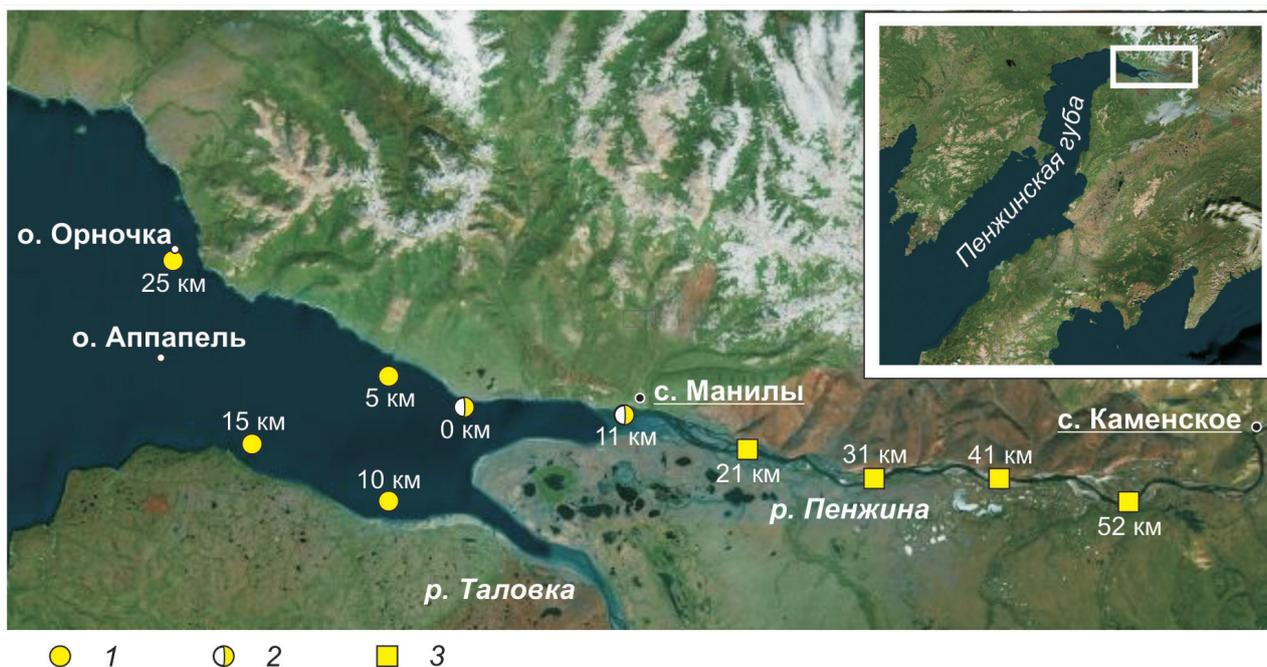
Рис. 1. Схема размещения автономных постов в устьевой области р. Пенжины (на фоне космического снимка): 1 — посты, на которых у дна стояли датчики уровня ( $H$ ), температуры ( $T$ ) и солености ( $S$ ) воды, а у поверхности датчики  $T$ ,  $S$ ; 2 — посты с датчиками  $H$ ,  $T$ ,  $S$  у дна; 3 — посты с датчиками  $H$ ,  $T$  у дна; расстояния указаны от устьевого створа р. Пенжины
