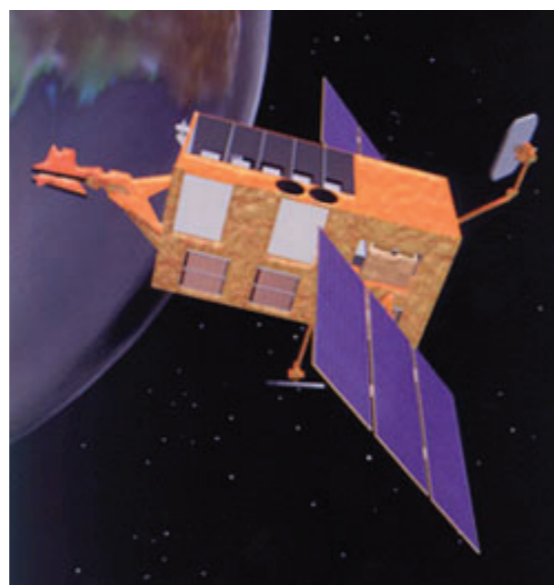
Обсерватория RXTE (1995-2012). Основной спектрометр этой обсерватории имел самую большую эффективную площадь (около 6400 кв.см) среди всех когда либо использовавшихся для наблюдений астрофизических рентгеновских объектов.
