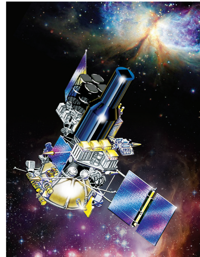
Обсерватория Гранат (1989-1999). Основные инструменты обсерватории представляли собой рентгеновские телескопы с кодирующими масками АРТ-П и СИГМА. Телескоп СИГМА был первым астрофизическим телескопом, способным строить изображения в диапазоне энергий выше 50 кэВ.
