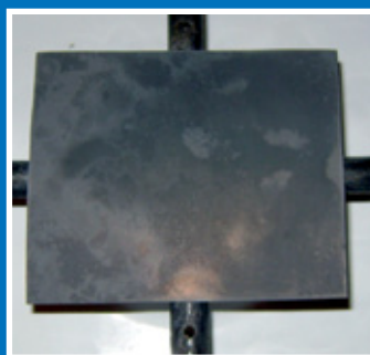
Rys. 2. Ogrzewana płytka miedzi z czarną powłoką tlenkową
