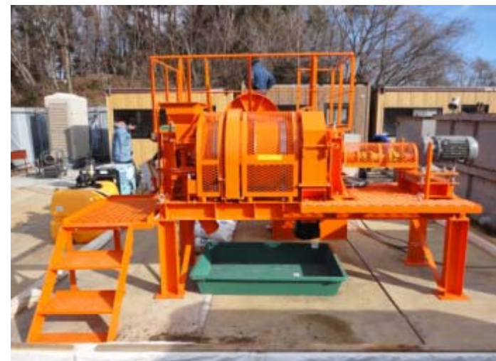
摩砕洗浄機 (洗浄部分：60cm×100cm)
