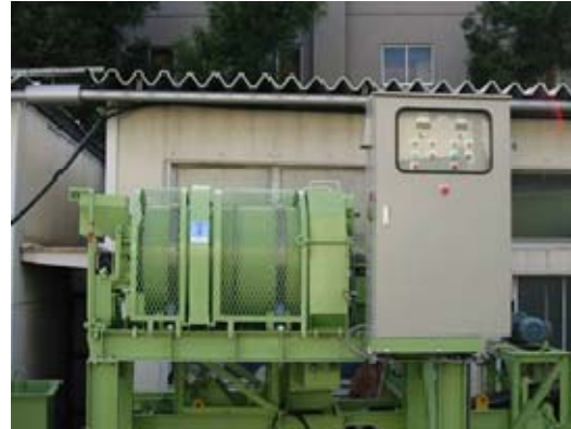
ロータリー式土壤洗浄機
