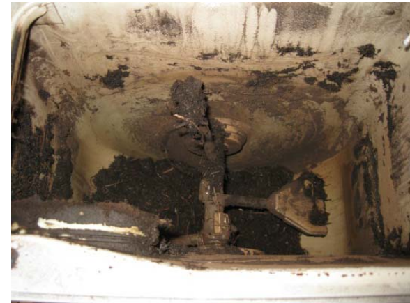
4日後 落ち葉は顆粒と繊維に分解され反応槽の底部に収まるほどに減容した。
