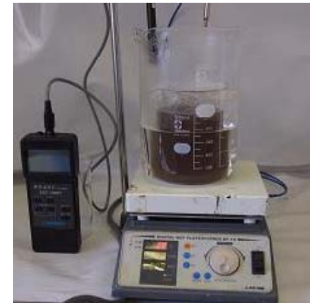
セシウム溶離試験の状況
