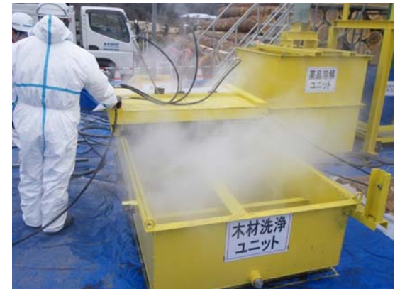
木材洗浄ユニット (高圧水洗浄)
