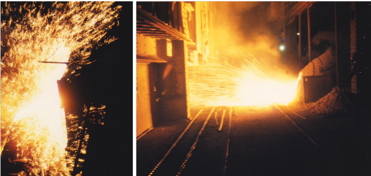
15 février 1969 : soufflage puis basculement du convertisseur pour couler dans une poche.
