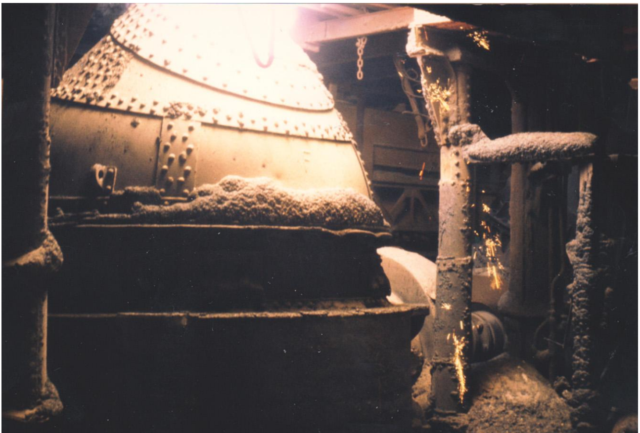
15 février 1969 : vue du convertisseur redressé après avoir terminé son ultime tâche, un triste symbole de 87 années de fabrication d'acier sur le site de l'usine de Jœuf.
