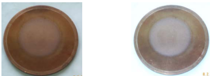
Рис. 13. Фотографии медного приемника после флуенса 10^{19} \text{ см}^{-2} без вспышки фотоаппарата (слева) и со вспышкой (справа).
