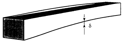
Fig. 6. «Twist» of the girder
