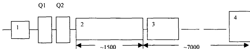
Рис. 1. 1 - магнит вывода, Q1 и Q2 – квадруполь, 2 - электростатический или магнитный сканеры, 3 - диагностическая камера, 4 - камера облучения образцов
