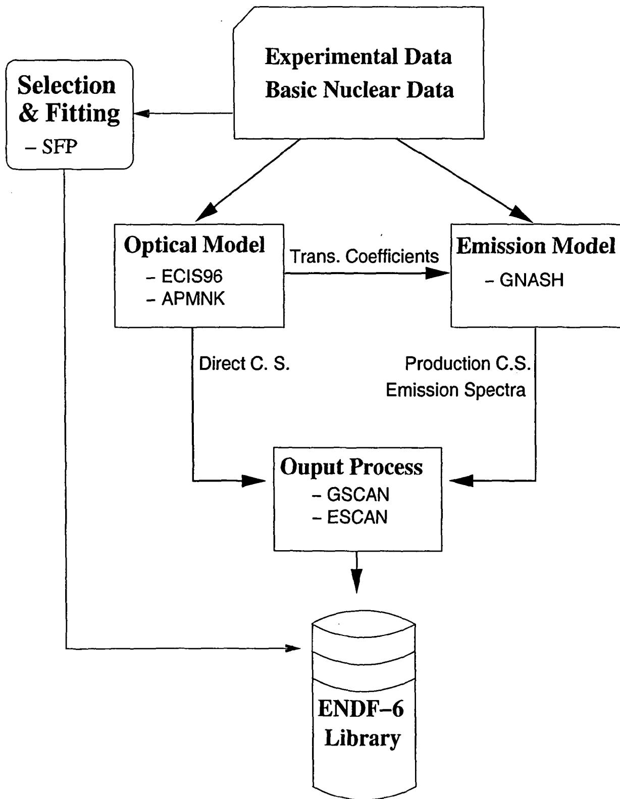
그림 1: Schematic Diagram of Evaluation of Charged Particle Nuclear Data
