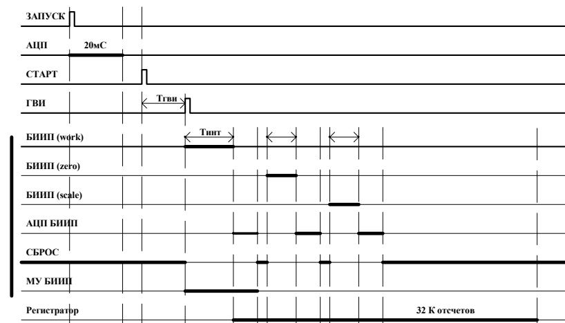
Рис.5 Временная диаграмма работы контроллера ГИМН
