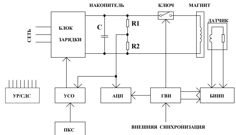
Рис.1. Функциональная схема ГИМН
