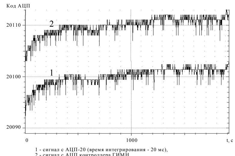
Рис.7 Процесс прогрева после включения питания
