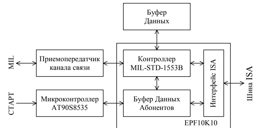
Рис.6 Структурная схема контроллера MIL-STD-1553B
