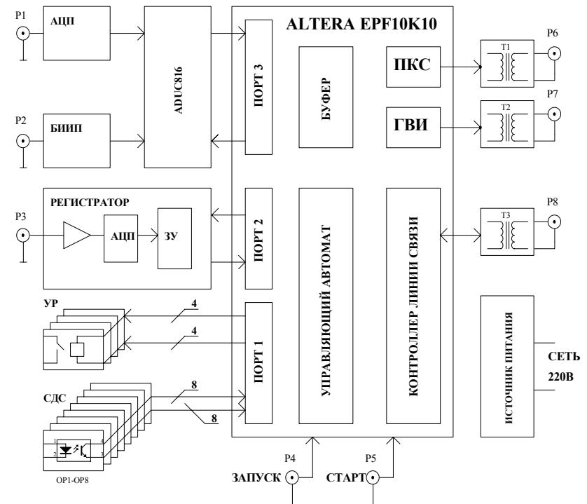
Рис.2. Структурная схема контроллера ГИМН
