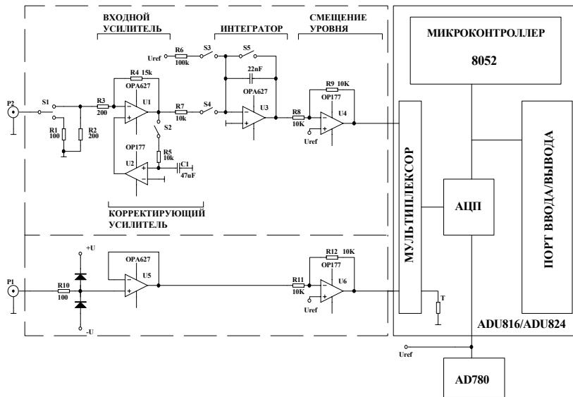
Рис.3. Функциональная схема аналогового тракта контроллера ГИМН
