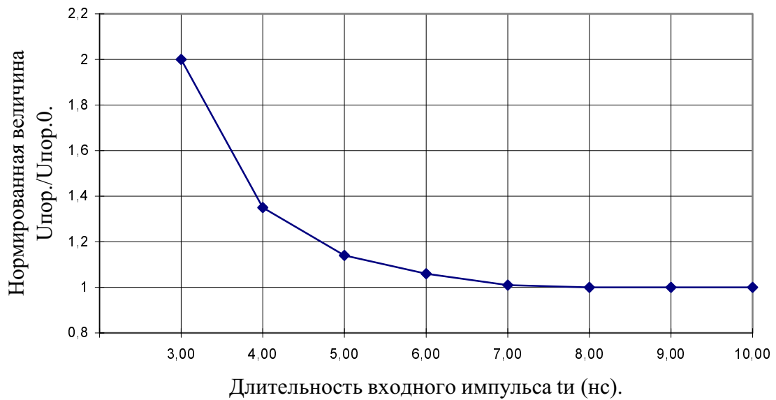
Рис. 5. Зависимость нормированной величины U_{пор.} / U_{пор.0} от длительности входного импульса t_{и} (нс). U_{пор.0} – величина порога при t_{и} > 10 нс.
