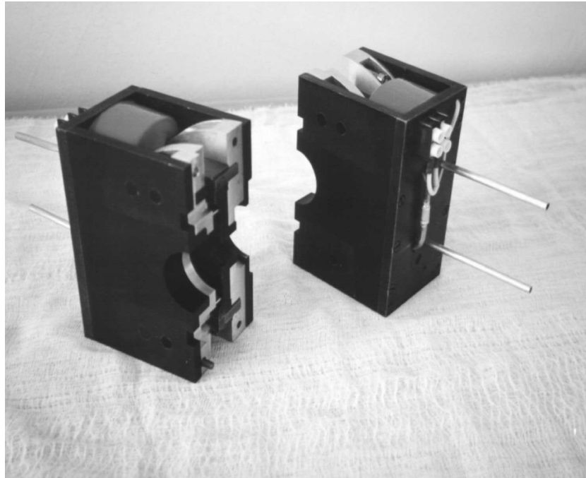
Рис. 10. Общий вид 2-составных модулей гибридной линзы Тошиба PPM клистрона.
