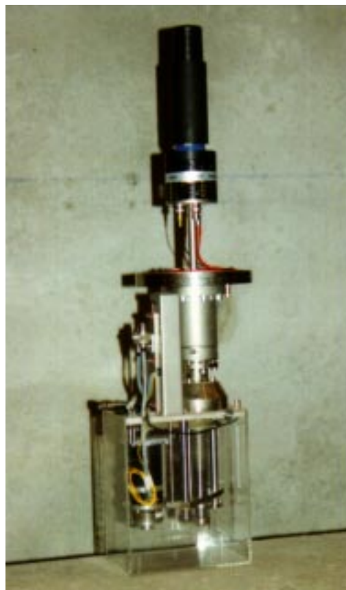
Abbildung 2.7: Der Startdetektor. Der Photomultiplier ist zur exakten Positionierung im Strahl auf einer Vorschubmechanik befestigt. Darauf befindet sich unter einer Schutzkappe vertikal und senkrecht zum Strahl ein dünnes Quarzglasplättchen
