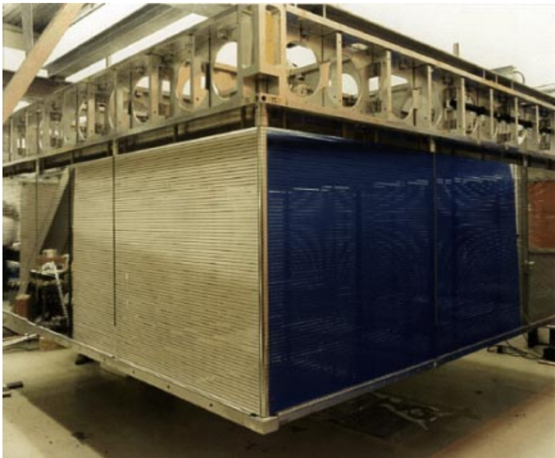
Abbildung 2.3: Eine der beiden MTPCs (Größe etwa 3.6 \times 3.6 \times 1.2 \text{ m}^3 )
