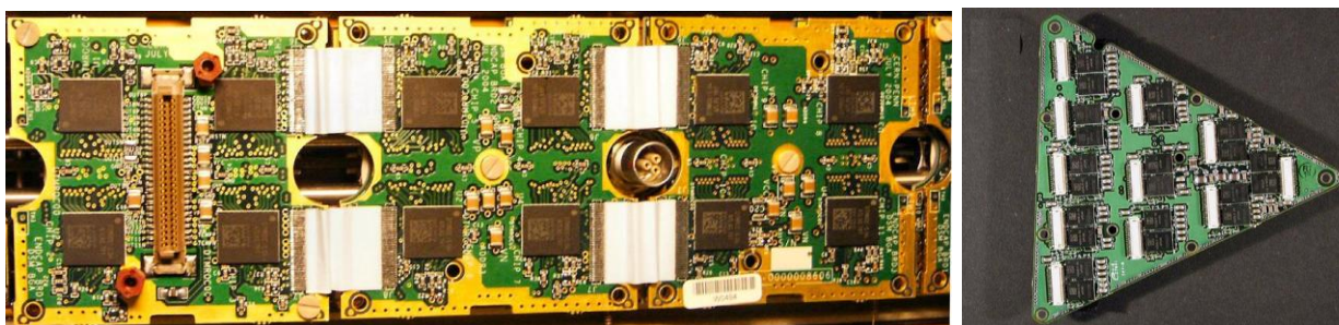
Рисунок 2-16 Интерфейсные панели электроники торцевой части (слева) и цилиндрической части детектора (справа)
