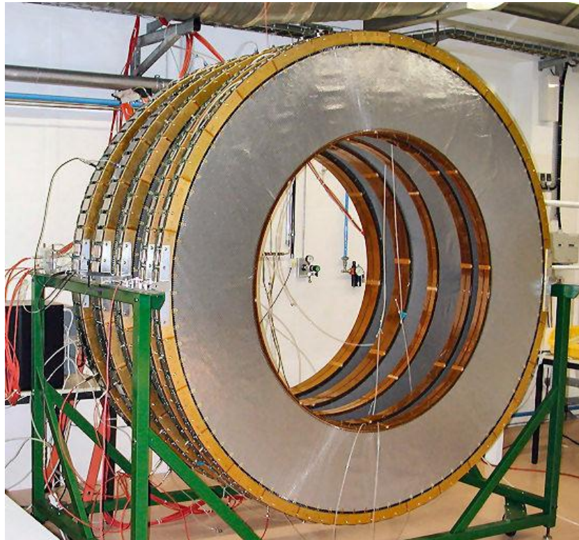
Рисунок 4-4 Высоковольтный стенд для проверки колес TRT на наличие утечек тока и пробоев по высокому напряжению
