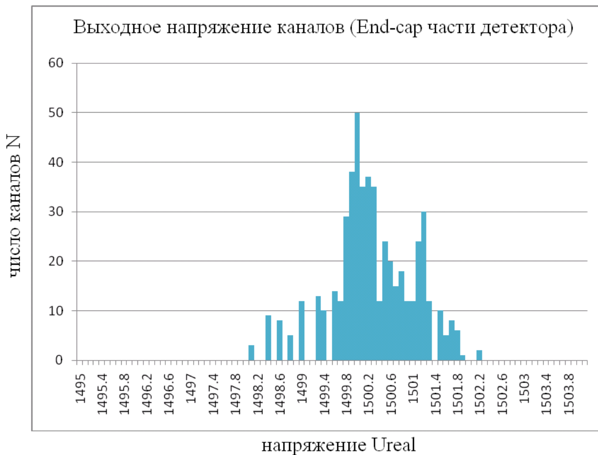
Рисунок 3-14 Распределение выходных напряжений U_{real} в крайтах торцевых частей детектора после калибровки. Установленное напряжение – 1500 В. Разброс \pm 2 В.
