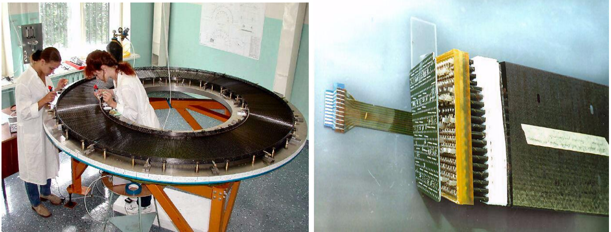
Рисунок 2-7 Сборка колес торцевых частей т.д.п.и в России (слева). Вид на модуль цилиндрической части т.д.п.и: печатная плата, пропорциональные камеры и радиатор
