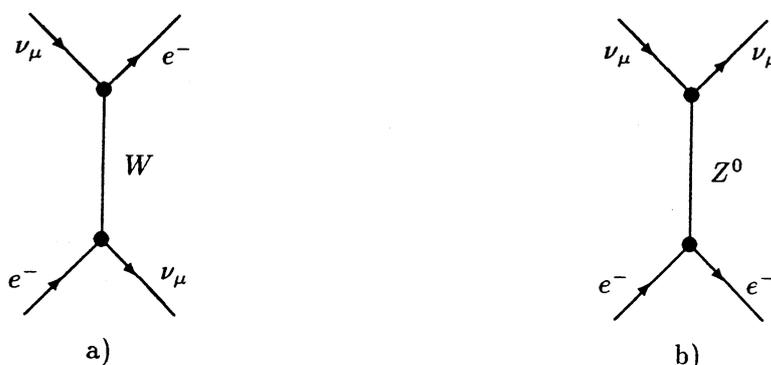
ABBILDUNG 2: Elastische  $\nu_\mu e^-$ -Streuung  $\nu_\mu e^- \rightarrow \nu_\mu e^-$ .
