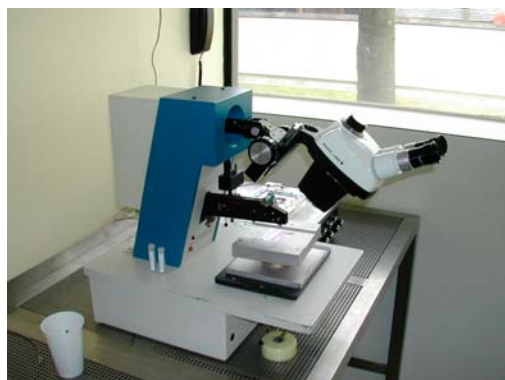
Figure 3-14: Vue de la machine à « Bonding » utilisée pour les contacts électriques.
