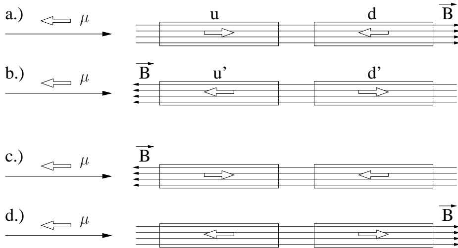
Abbildung 2.14: In der Targetkonfiguration a ist die erste Targetzelle u („upstream“) antiparallel und die zweite Targetzelle d („downstream“) parallel zum Myonspins polarisiert. In b sind die Targetzellen u' und d' im Vergleich zu a entgegengesetzt polarisiert und das Targetmagnetfeld hat seine Richtung geändert. Die Targetkonfigurationen c und d lassen sich (im Vergleich zu a und b) mit einer unterschiedlichen Mikrowelleneinstrahlung erreichen (siehe Abschnitt 3.2).
