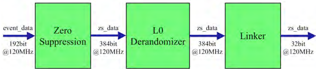
Abbildung 4.9: Blockschaltbild des Daten-Prozessors einer ersten Studie. Der L0-Derandomizer befindet sich hier nach der Null-Unterdrückung der Daten. Auf Grund der Busverbreiterung während der Verarbeitung ist der Derandomizer im FPGA stark fragmentiert. Ein Linker sorgt für das Multiplexen der Daten und die Erzeugung der ZS-Bank.
