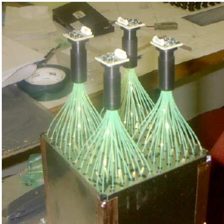
FIG. 2.17 – Module d'EMCal, avec les fibres de verre reliant les scintillateurs aux APD.
