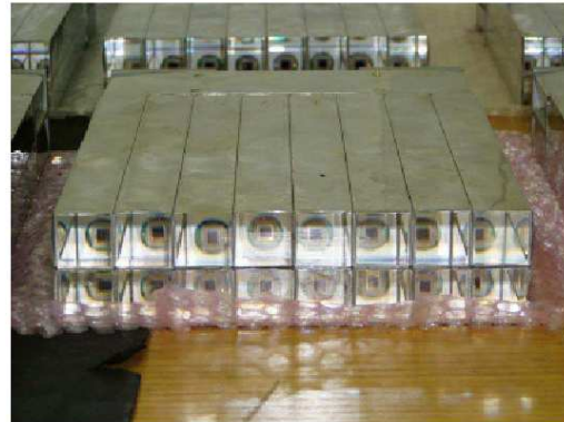
FIG. 2.10 – Détails de PHOS : à gauche un cristal PWO seul, à droite, un ensemble de ceux-ci assemblés en un module EMC.
