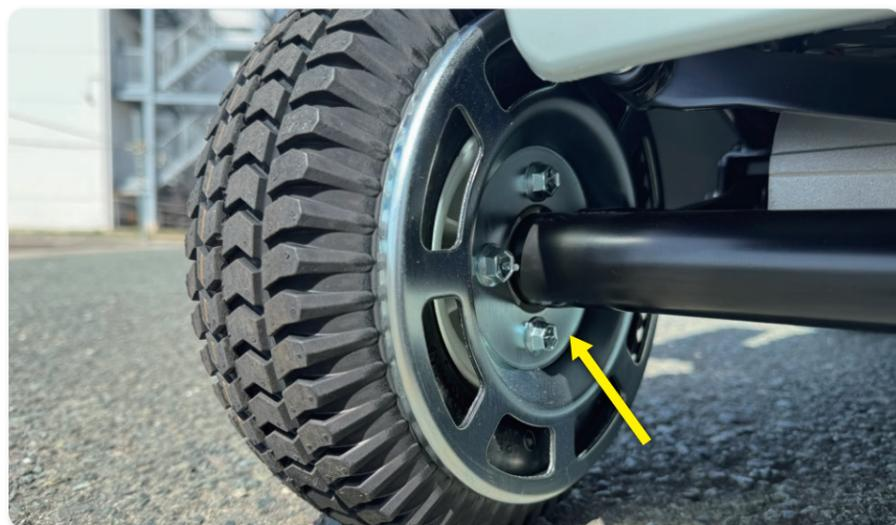
1度でも脱輪して衝撃を受けたサブホイールプレートはそのまま使用せず交換してください。
