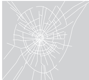
<合わせガラスが割れた状態>
